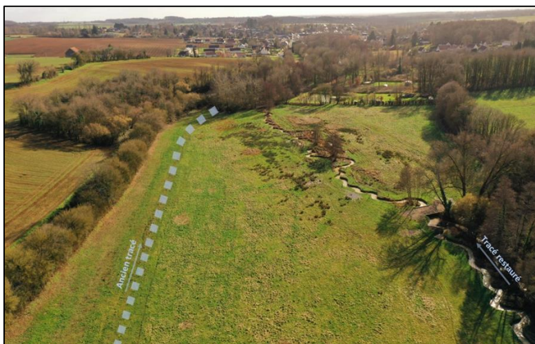
Figure 71 : Action R3 de remise en fond de vallée et reméandrage à Saint-Martin-d'Auxigny (Source : SIVY, 2022)
