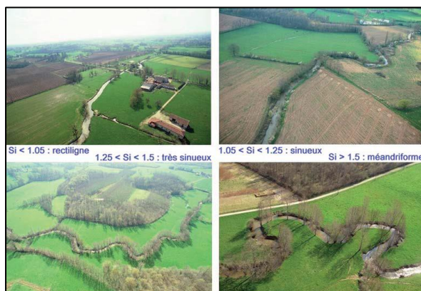
Figure 7 : Les différentes classes de sinuosité en fonction du coefficient SI (Source : MALAVOI et BRAVARD, 2010)
