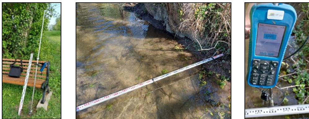
Figure 30 : Mesure des débits avec un courantomètre (Source : CHARONNAT, 2022)
