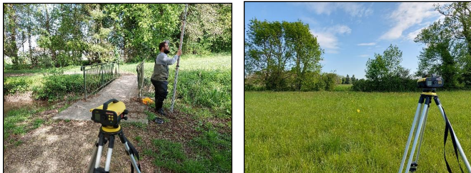
Figure 29 : Mesure de profils avec la lunette topographique et la mire (Source : CHARONNAT, 2022)
