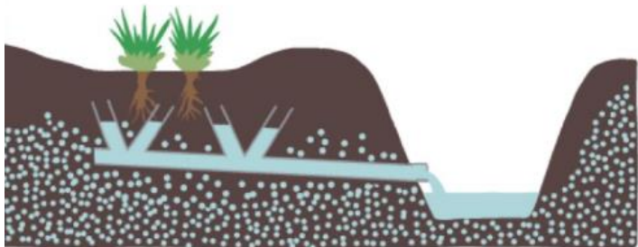
Figure 13 : illustration du drainage de sols humides
